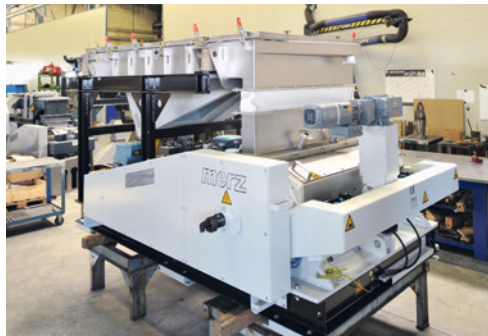
Wassergekühlte Walzenmühle mit elektrischer Mahlsplattverstellung und Förderrinne
